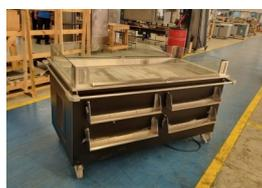
Expositor refrigerado de alimentos preparados no ponto de vendas, fabricado com pista refrigerada de inox, com controlador de temperatura que mantém a refrigeração ideal de conservar e servir alimentos; Utilizado como balcão expositor refrigerado, balcão de auto atendimento e pista fria em pontos de auto de atendimento e lojas de supermercados; Gabinete em MDF; Vidros temperados e puxadores laterais; 220v monofásico; Potência 0,4 kw; Preço de expositor refrigerado direto da fábrica.
